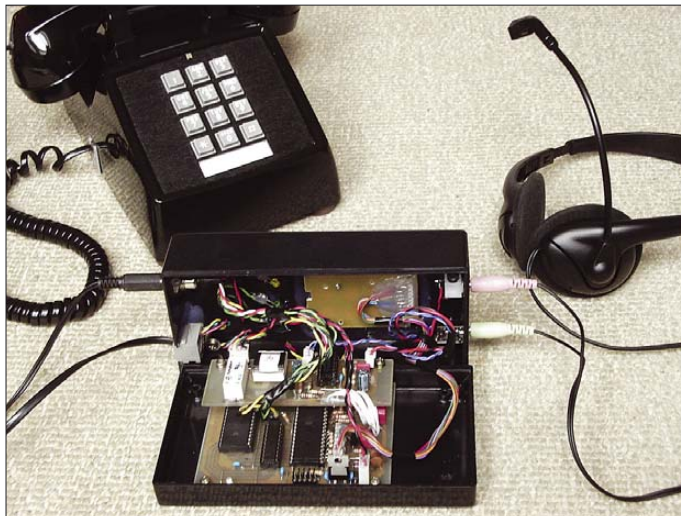
Bild 1: Der eher unscheinbare Verschlüsseler, hier im geöffneten Zustand, wartet mit inneren Werten auf. Per Tastendruck lässt er sich einfach in eine bestehende Verbindung einschleifen und gewährleistet dann die abhörsichere Sprachübertragung.
