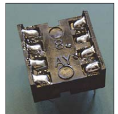
Bild 3: Das vorsichtige Verzinnen der Kontakte der IC-Fassung bildet den Schritt 1 zum Adapter.
