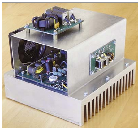
Bild 3: Die eigentliche Endstufe besteht aus zwei Modulen nebst Leistungsaufteilung und -zusammenführung. Fotos: OE2KHM
