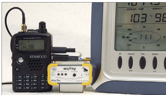
Bild 2: Durch seinen winzigen Aufbau und intelligente Features lässt sich der APRS-Controller anyfrog nicht nur stationär zur Übertragung von Wetterdaten einsetzen, sondern auch mobil sinnvoll betreiben.
