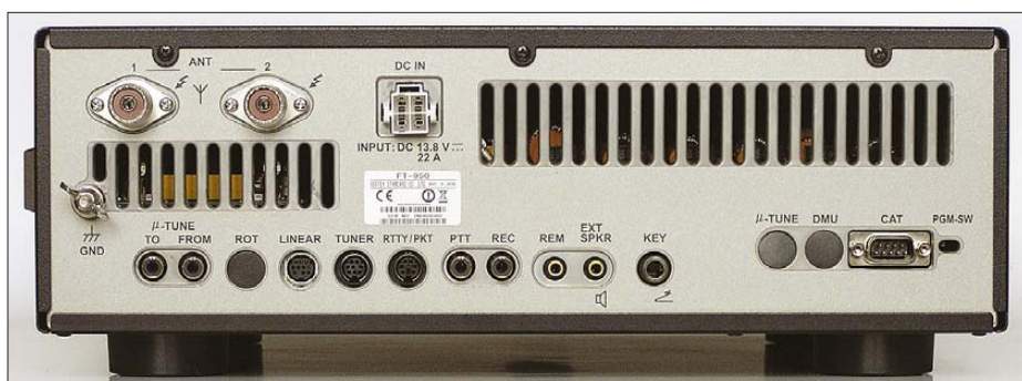
Bild 2: Rückansicht des FT-950. Der Lüfter befindet sich im Innern; die erwärmte Luft strömt durch die Schlitzze. Die Beschriftung der Buchsen ist auch bei ungünstiger Beleuchtung gut zu lesen. Man beachte die Stopfen in drei der Buchsen.
