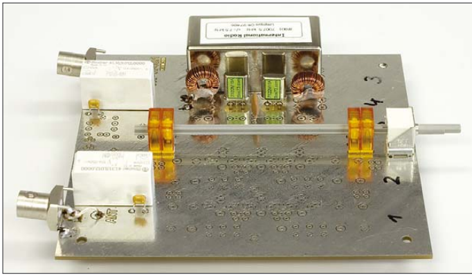
Bild 22: Hier sind Schaltkästen sowie Schaltschwert sichtbar und zugänglich. Die BNC-Buchsen dienen lediglich Messzwecken.
