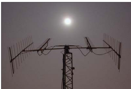
Die zwei Zepp-Element-Yagis bei BY4RRR sind vertikal polarisiert; über den Mond macht das wenig Unterschied. Auch auf 70 cm ist die EME-Gruppe der Universität Nanjing QRV. Foto: BD5RV
