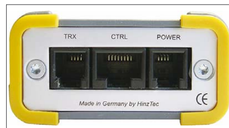
Bild 5: Für den Anschluss an die Western-Modularbuchsen liegen dem Gerät bereits konfektionierte Anschlusskabel bei, die nur noch mit passenden Steckern für Wetterstation bzw. GPS und Funkgerät versehen werden müssen.
