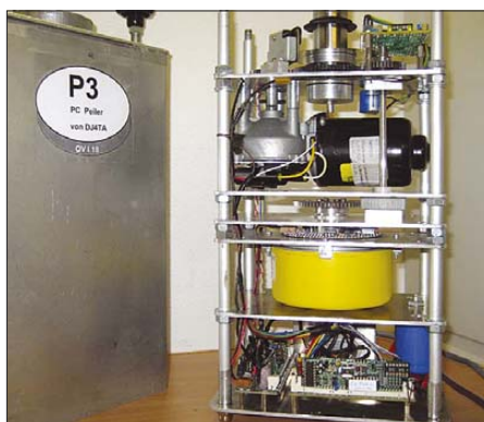
Bild 2: Innenansicht des Peilers
