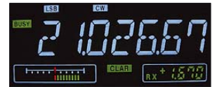
Bild 8: Die Abstimmenskala kann auch als Relativanzeige der Sende-/Empfangs-Ablage dienen. Der Vergleich beider Bilder zeigt, dass die Anzeige nichtlinear verläuft, also bei geringeren Werten empfindlicher ist.
