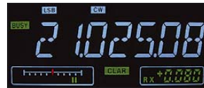
Bild 7: Oben: so sieht die CW-Feinabstimmung auf der Abstimmenskala bei einem auf Schwebungsnull (Zero Beat) eingestellten starken Empfangssignal aus; unten dasselbe Signal mit der RIT um 80 Hz verstimmt.
