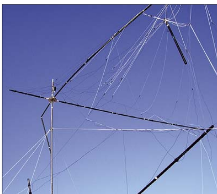
Der beim Sturm beschädigte Spider-Beam
