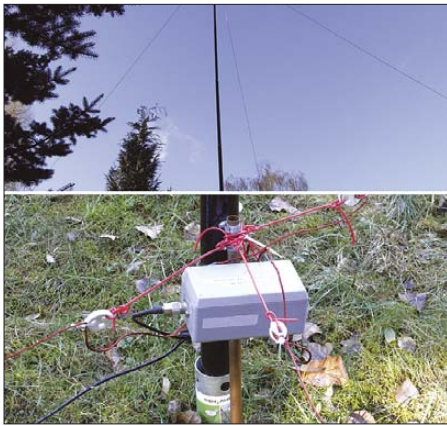
Bild 12: K9AY-Empfangs- antenne in der Praxis
