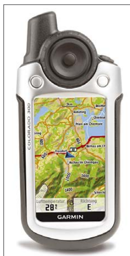
Bild 5: GPS-Handgerät Colorado 300: Routinganzeige (Garmin)
