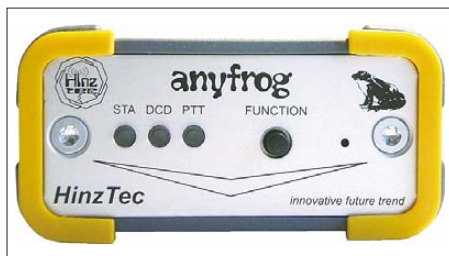
Bild 1: Für den schnellen Überblick über alle Funktionen und die Bedienung genügen drei Leuchtdioden und ein Taster.
