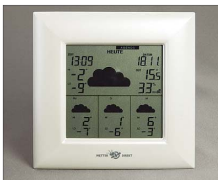
Bild 4: Ohne Folie und eingeschaltet: nach einigen Minuten erscheint das Wetter, bis zu vier Tage im Voraus, nach morgens, mittags, abends und nachts sowie Höchst- und Tiefsttemperaturen sortiert.
