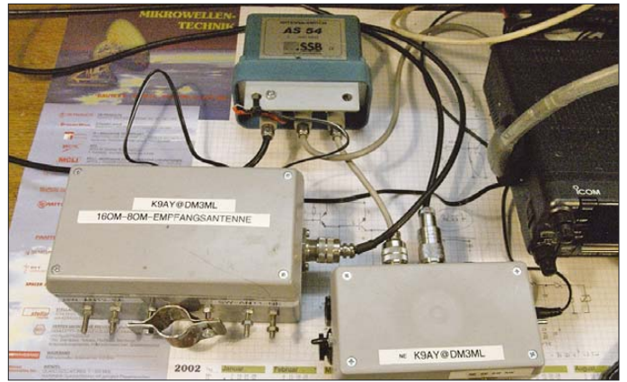
Bild 13: Versuchsaufbau von Anschlusskasten und Steuergerät der K9AY-Empfangs- antenne am Messplatz Fotos: DM3ML
