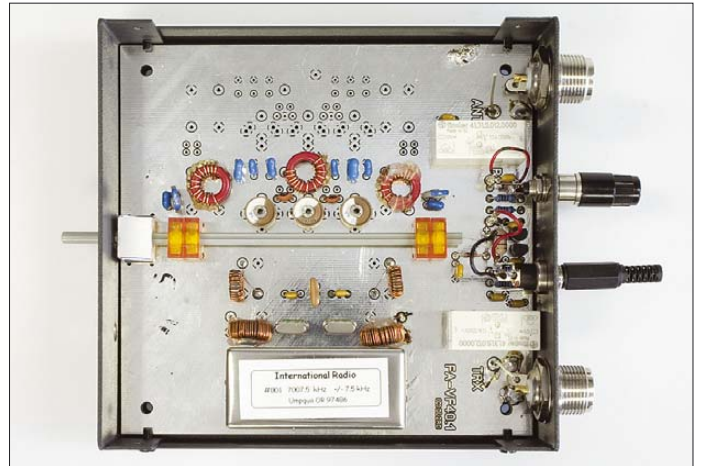
Bild 23: Erprobte Platine beim Einbau in das Gehäuse; die Verbindungen zu den SO239-Buchsen sind hier noch anzulöten.
